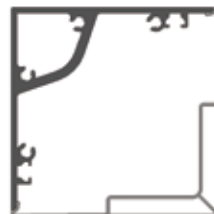
Coupe du poteau Canal d'évacuation
